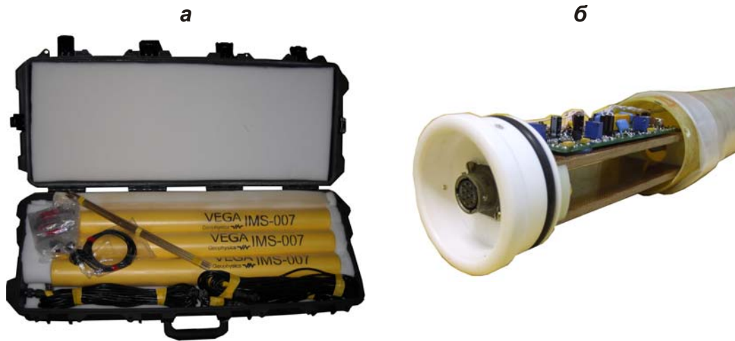
Рис. 10. Внешний вид комплекта датчиков IMS-007 (а) и предварительный усилитель (б)
