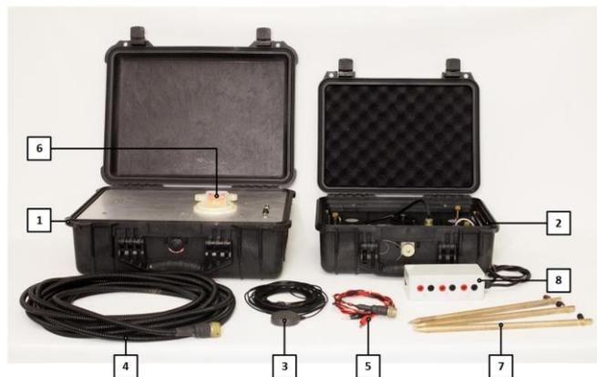
Рис. 1. Внешний вид геофизической станции GI-MTS-1: 1 – регистратор MTS-R, 2 – магнитометр MS, 3 – GPS-антенна, 4 – кабель связи MS и MTS-R, 5 – кабель питания 12 В для АКБ, 6 – карта памяти CF, 7 – электроды, 8 – коммутатор подключений внешних датчиков
