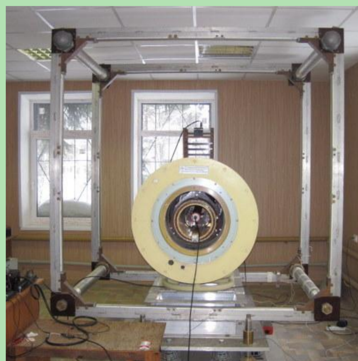
Калибровка датчиков IMS-008 в многослойном пермалоевом экране (Март - Апрель 2011, СПб)
