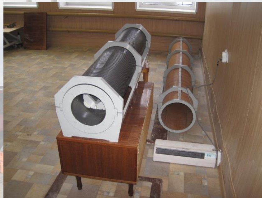
Установки для тестирования индукционных датчиков в полевых условиях
