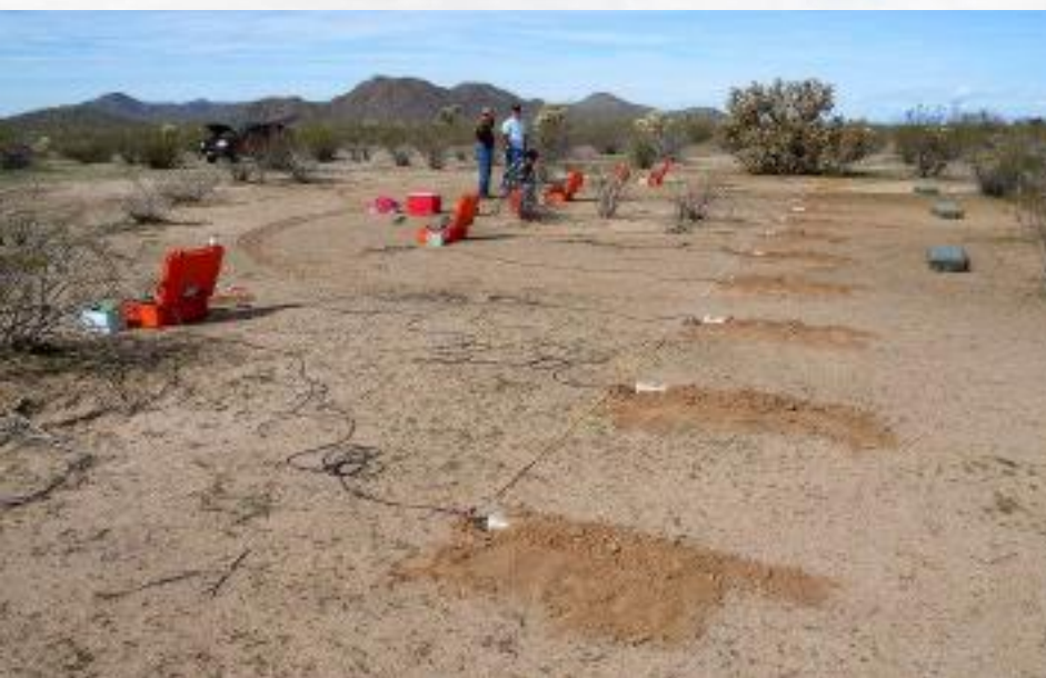
Проверка датчиков на идентичность (естественный сигнал)
